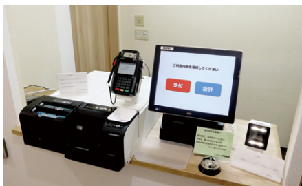
入店してすぐのフロントにある自動受付／精算機。3階、4階フロアのそれぞれに1台ずつ設置され、各フロアのルームの扉につけられたスマートロックと連動している
