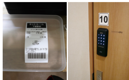
タッチパネルでルームと料金パックを選ぶと、4桁の入室キーとバーコードが記されたレシートを発行(左)。ルーム扉の小型パネルに4桁を入力すると開錠される(右)
