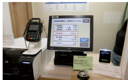
タッチパネルの右横にある読み取り機にレシートのバーコードをかざして、自動精算機で精算。現金、クレジットカード、QRコードなど多彩な精算方法に対応する
