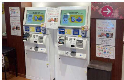
自動精算機を2台設置。決済はクレジットカード、ICカード、QRコードなどに対応
